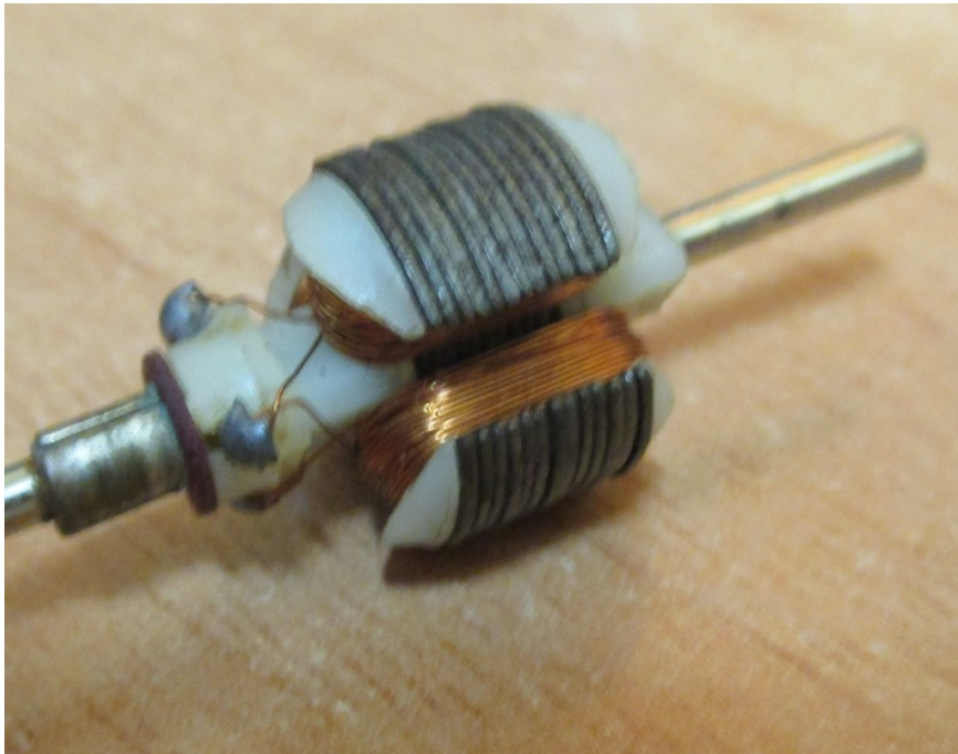
Imagen del rotor inductor de un motor eléctrico de corriente continua
